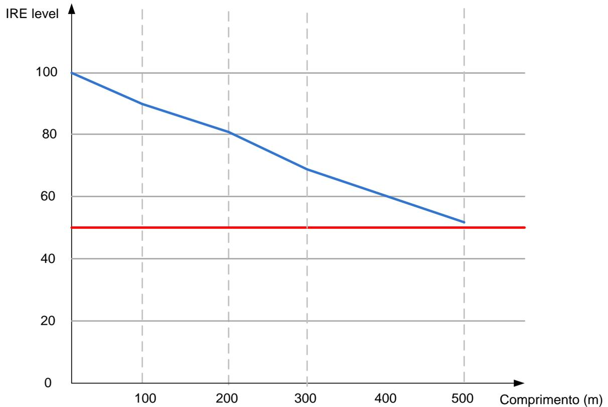
O cabo manteve um nível de sinal de vídeo acima de 50 IRE para todos os comprimentos testados, o que o torna adequado para uso com câmeras em cenas de iluminação constante para até 500 m de comprimento. Para uso outdoor, sem iluminação auxiliar, pode ser utilizado para até 300 m.
